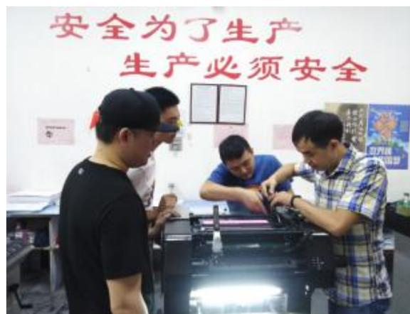
的和内容，以老带新引导大家学习新技术、掌握新本领。充分发挥培训基地的作用，利用班后时间开展交流互学，通过对胶印机进行拆卸讲解、描述、故障的排查、处理分享等，让大家互相交流学习，更直观、全面地了解和掌握设备结构、设备性能、工作原理和操作流程，有效提高了员工处理突发事故的能力。
